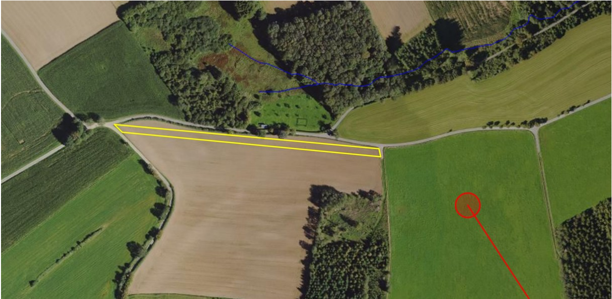
Abbildung 82: Mit Stahlplatten auszulegender Bereich bei der Bauzufahrt zu WEA1.
